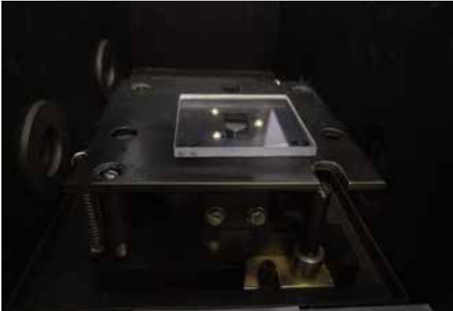
Slika 7 : Namestitvev stekla v spektrofotometer
